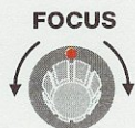
Fig.6 La manopola indicata FOCUS (vedi fig.1) serve per mettere a "fuoco" la traccia del segnale in modo da vederla perfettamente nitida e ben definita.
