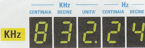
Fig.6 Se nel frequenzimetro leggerete un valore in 832,24 KHz, dovreste convertirlo in MHz dividendolo x 1.000. Per una frequenza di 0,83224 MHz il valore del condensatore risulterà di 270 pF.
