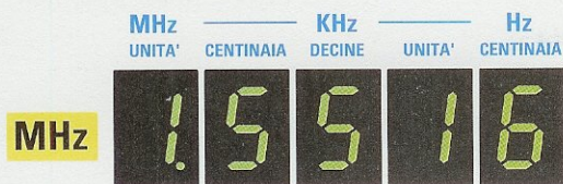
Fig.5 Se nel frequenzimetro leggerete una frequenza di 1,5516 MHz, il condensatore avrà una capacità di 10 pF. Vedi l'esempio descritto nell'articolo ed anche il valore riportato nella Tabella N.1.
