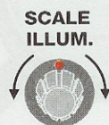
Fig.7 La manopola SCALE ILLUM. viene utilizzata solo per illuminare il "reticolo" dello schermo per meglio visualizzare la posizione occupata dal segnale.
