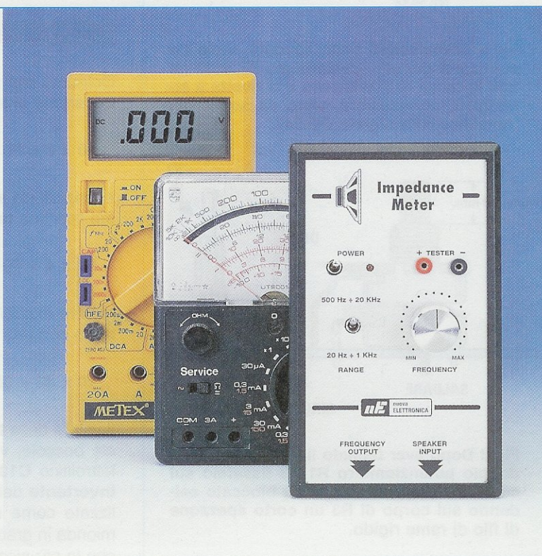
Fig.3 All'uscita del nostro circuito possiamo applicare sia un Tester Digitale commutato sulla portata 200 millivolt CC che un Tester Analogico commutato sulla portata di 0,3 volt CC.
